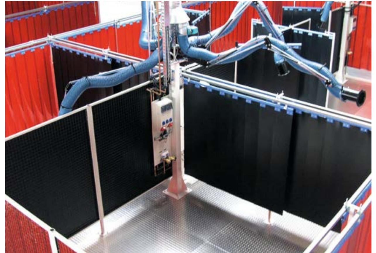
Kabinensystem seitenschiebbar mit Schwenkarmen, Lamellen 300 x 2 Orange und Dunkelgrün R9
