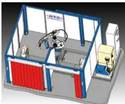
**Schweißroboter-Anlage mit 2 Horizontalwendern**
