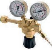
C265200 | <b>Flaschendruckminderer MAXY<br/>CO<sub>2</sub> / Argon</b> <ul style="list-style-type: none"> <li>• Nenneingangsdruck bis 300 bar</li> <li>• Durchflussmenge 0 - 30 L/min</li> <li>• Anschluss Eingang: W21,80 x 1/14" RH</li> <li>• Anschluss Ausgang: 1/4" RH</li> <li>• Manometer: Ø 63 mm   Membran: Ø 50 mm;</li> </ul> |
