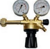
C246501 | <b>MAXY SMART PowerControl<br/>mit Absperrventil CO<sub>2</sub> / Argon</b> <ul style="list-style-type: none"> <li>• Nenneingangsdruck bis 300 bar</li> <li>• Durchflussmenge 0 - 30 L/min</li> <li>• Anschluss Eingang: W21,80 x 1/14" RH</li> <li>• Anschluss Ausgang: 1/4" RH (ohne Tülle)</li> </ul>                       |
