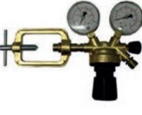
C241551 | <b>MAXY SMART PowerControl<br/>mit Absperrventil Acetylen</b> <ul style="list-style-type: none"> <li>• Nenneingangsdruck bis 25 bar</li> <li>• Ausgangsdruck: 1,5 bar</li> <li>• Anschluss Eingang: Bügel</li> <li>• Anschluss Ausgang: 3/8" LH</li> </ul>                                                                     |
