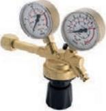
C246201   | <b>MAXY SMART<br/>CO<sub>2</sub> / Argon</b> <ul style="list-style-type: none"> <li>• Nenneingangsdruck bis 300 bar</li> <li>• Durchflussmenge 0 - 30 L/min</li> <li>• Anschluss Eingang: W21,80 x 1/14" RH</li> <li>• Anschluss Ausgang: 1/4" RH (ohne Tülle)</li> </ul>                                                      |
