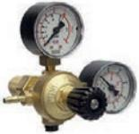
C256201   | <b>Flaschendruckminderer MINI<br/>CO<sub>2</sub> / Argon</b> <ul style="list-style-type: none"> <li>• Nenneingangsdruck bis 300 bar</li> <li>• Durchflussmenge 0 - 30 L/min</li> <li>• Anschluss Eingang HINTEN: W21,80 x 1/14" RH</li> <li>• Anschluss Ausgang: 1/4" RH (ohne Tülle)</li> </ul>                               |
