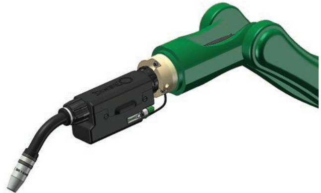
Hohlwellenroboter mit Pistolkopf, Antriebseinheit und Anschlusskörper, Anwendungsbeispiel
