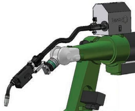
Drahtvorschub nur in Verbindung mit DINSE Stromquellen einsetzbar (optional) - Anwendungsbeispiel
