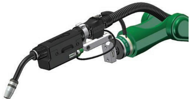
Roboter- Automatenanwendung mit Pistolkopf, Antriebseinheit, Sicherheitsabschaltung und Pistolhalter-System, Anwendungsbeispiel
