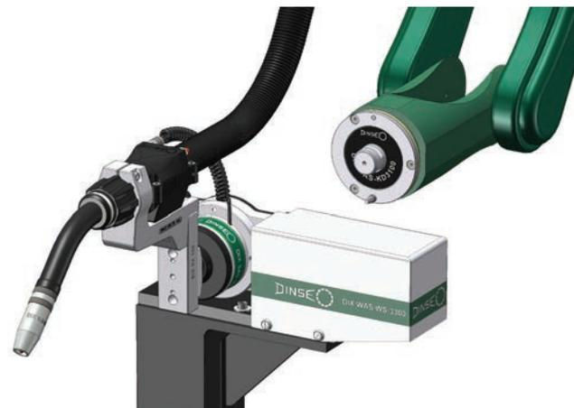
Pistolensystem in der Ablagestation vom Roboter abgekuppelt
