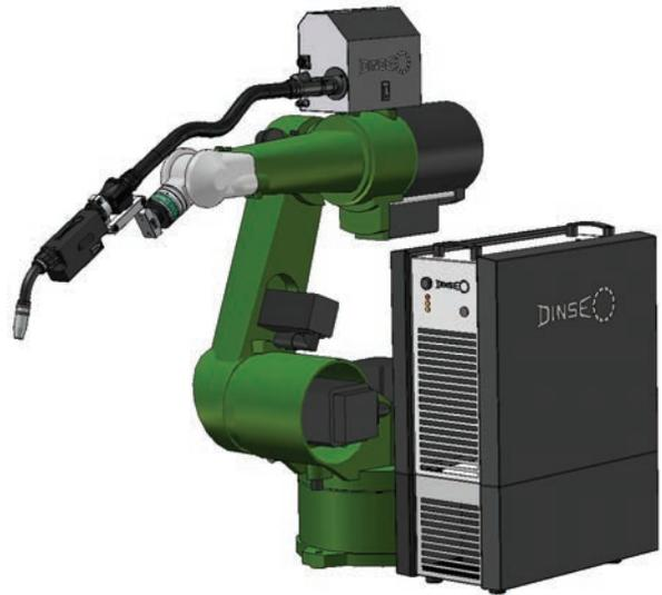
Gerätesystem mit Stromquelle, Kühlmodul und Drahtvorschub Anwendungsbeispiel
