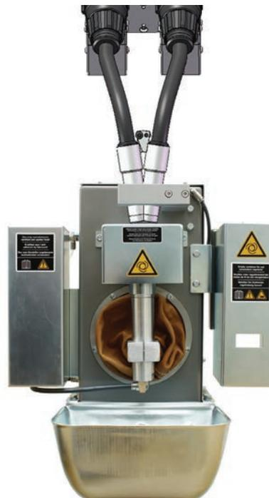
Roboter mit montiertem Dinse - Tandem Pistolenkopf während des Reinigungsvorgangs in der Tandem Pistolenreinigungs - Station
