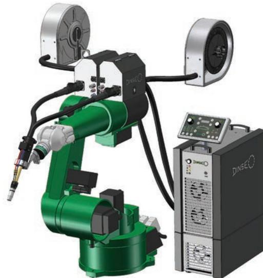
Gerätesystem mit Stromquelle, Kühlmodul, Drahtvorschüben und Drahtspulenhalter, Anwendungsbeispiel mit **DIX MEDD 7000 SAZ**
