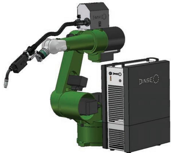
Gerätesystem mit Stromquelle, Kühlmodul und Drahtvorschub Anwendungsbeispiel
