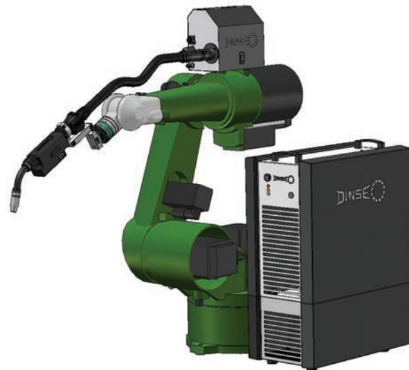
Gerätesystem mit Stromquelle, Kühlmodul und Drahtvorschub
