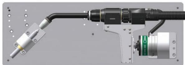
Prüfvorrichtung mit komplettem Pistolensystem, doppelt trennbar, Pistolenthaler, PUSH-PUSH/PUSH-PULL und Sicherheitsabschaltung DIX SAS 200 (Anwendungsbeispiel)
