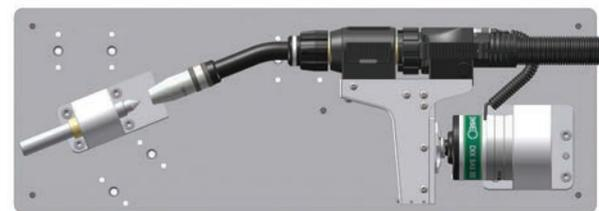
Prüfvorrichtung mit komplettem Pistolensystem, doppelt trennbar, Pistolenthalter, PUSH-PUSH/PUSH-PULL und Sicherheitsabschaltung DIX SAS 200 (Anwendungsbeispiel)
