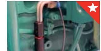
Verschiedene **Vorheizungssysteme** sind erhältlich als Option, wie Kühlwasserheizung, Ölwanneheizung, Lufterwärmung. Dies ermöglicht, den Motor in einer **extrem kalten Umgebung** zu starten.
