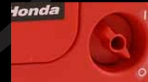
Der Ein/Aus-Schalter auf EPSi1000 stoppt den Motor und schließt die Kraftstoffversorgung **gleichzeitig** ab, was verhindert, dass Benzin in die **Ölwanne** des Motors **läuft**.
