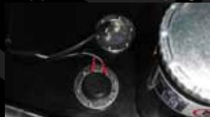
Die doppelte Kraftstoffpegel-**Überwachung** erzeugt zuerst einen Alarm, wenn niedriger **Kraftstoffpegel** erreicht ist, und sorgt für Abschaltung des **Motors**, bevor der Tank ganz leer ist. Dies stellt sicher, dass Sie nie das Kraftstoffsystem des Motors entlüften müssen.
