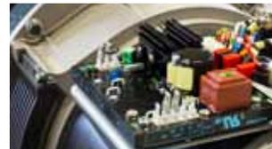
AVR steht für **Automatic Voltage Regulator**, um eine konstante und **stabile Spannung** zu behalten. Dies führt zu einer besseren Leistung für empfindliche Geräte.
