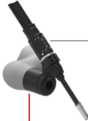
Schlauchpaket Cobot mit Tasten für
