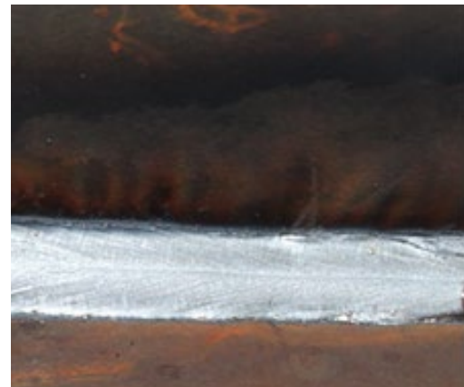
S355, t=10 mm, T-Stoß, Kehlnaht ohne Schweißnahtvorbereitung Schweißstrom = 316A, Schweißspannung=28,8V, DV = 10,5 m/min, vs = 50 cm/min
