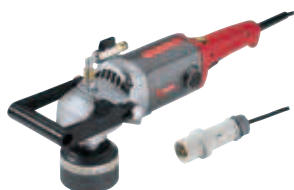
LW 1202 1600 Watt Nass-Steinpolierer mit Stecker für Trenntrafo, 130 mm Bestell-Nr. 276.375
