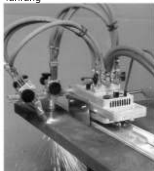
ProFIT® mit Kreisschneideinrichtung für automatische Kreisschnitte
