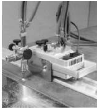
ProFIT® für automatische Geradeschnitte durch Laufbahnführung
