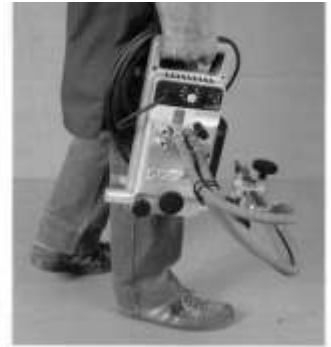
ProFIT® ist aufgrund eines Leichtmetallgehäuses bequem tragbar
