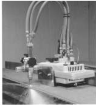
ProFIT® für automatische Geradeschnitte durch Winkelprofil-führung
