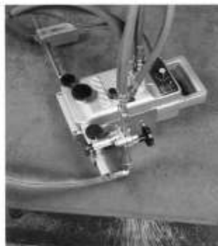
ProFIT® mit einseitig angeordneten Brennern für Schweißkanten Schnitte
