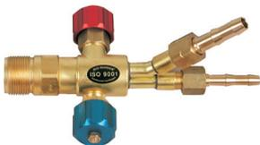
Zum Einspannen, für stationären Betrieb. Durchsatzleistung 15 m<sup>3</sup>/h, Anschluß: Sauerstoff 1/4", Brenngas 3/8" LH.
