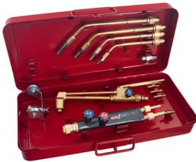
Die Garnitur ist ideal für Hartlötarbeiten, bei denen höhere Flammtemperaturen gefordert werden. Mit einer Propan-Sauerstoffflamme können Temperaturen bis ca. 2800 °C erreicht werden. Die Düsengeometrie der Löt- und Wärmeeinsätze erzeugt eine spitz zulaufende, zentrische Primärfür flamme, die zurückliegende Primärflamme bewirkt einen zusätzlichen Schutz vor der Atmosphäre. Ein weiterer Vorteil:
