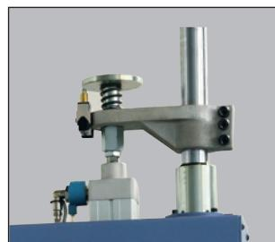
Pneumatischer Reitstock mit Mikroschaltern zur Werkstückerkennung
