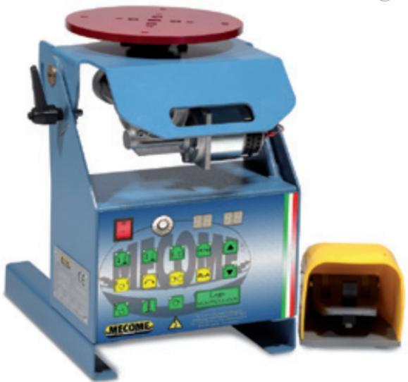
Bei den Anlagen PL handelt es sich um Schweißdrehstühle oder Säulen für manuelles oder automatisches Rundschweißen mit Traglasten von 30 bis 180 kg. Alle Modelle können von 0° auf 90° geneigt werden, mit Positionierung je 10° und variabler Geschwindigkeit mittels Potenziometer.
