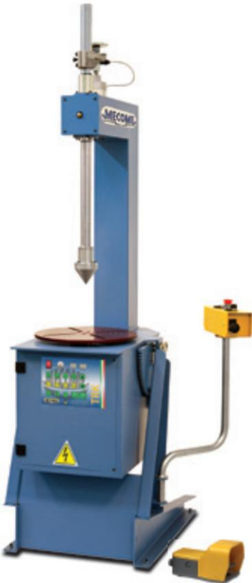
Bei den Anlagen TRK handelt es sich um Schweißdrehtische oder Säulen für manuelles oder automatisches Rundschweißen mit Traglasten von 35 bis 150 kg. Alle Modelle können von 0° auf 90° geneigt werden, mit Positionierung je 10° und variabler Geschwindigkeit mittels Potenziometer. Für diese Serie von Stellwerken mit Pedal für die Start/Stop-Befehle bietet MECOME zwei Arten Steuerung an:
