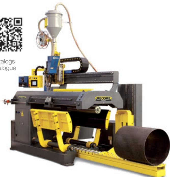
Das Angebot der Spannwerkbanken BR wurde für das Stumpfschweißen von kreisförmigen oder rechteckigen Behälterwänden oder Flachblechen mit Dicke von 0,5 bis 10 mm und einer Länge von 500 bis 6000 mm realisiert. Die anwendbaren Schweißtechnologien sind MIG/MAG, TIG, PLASMA und UP-Schweißen. Das System kann problemlos über eine numerische Steuerung mit Touchscreen-Schnittstelle gesteuert werden. Die zu schweißende Naht ist auf einem Profil in Cu-Cr-Zr-Legierung, die sie sehr widerstandsfähig
