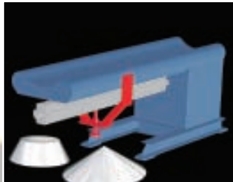
Mechanische Halterung für Kegelschweißen Support mécanique pour soudure des cônes
