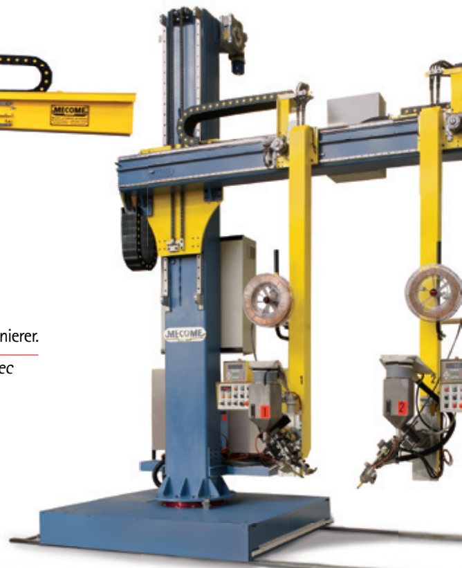
MABF 4x4 mit UP-Schweißtechnologie und PROBE zum Schweißen von Kasträgern.
