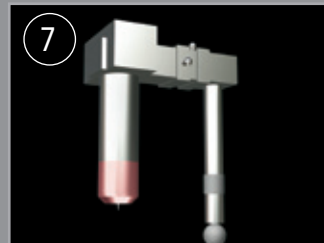
Mechanisierter Höhenabtaster Palpeur mécanique
