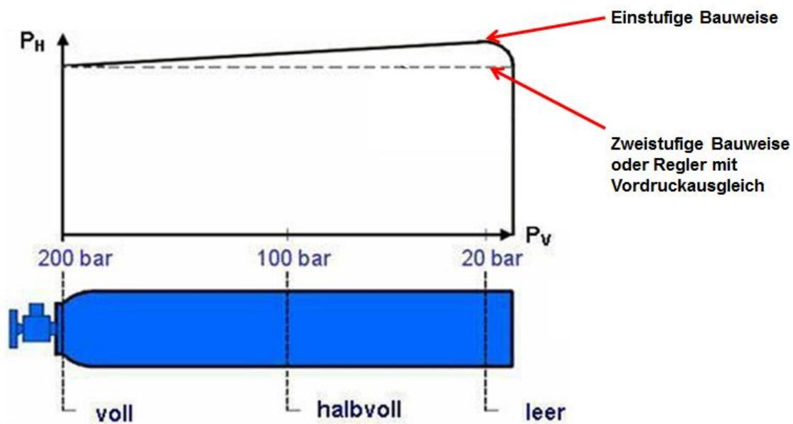
Die Abhängigkeit zwischen Eingangsdruck und Ausgangsdruck führt bei einstufigen Druckreglern bei zunehmender Entleerung der Flasche zu einem leichten Anstieg des Ausgangsdrucks. Dies kann ggf. eine Nachregulierung des Arbeitsdrucks erforderlich machen.
