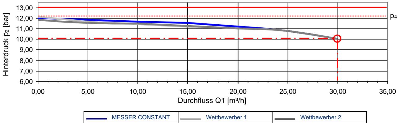
Um die Geräteklasse 3 der DIN EN ISO 2503 zu erfüllen, wird der Flaschendruckregler bei einem Vordruck für die Prüfung  $p_3$  ( $p_3 = 2 \times p_2 + 1 \text{ bar}$ ) = 21 bar, auf einen Hinterdruck  $p_2 = 10 \text{ bar}$  und einen Nenngasdurchfluss  $Q_1 = 30 \text{ m}^3/\text{h}$  eingestellt. Bei dieser Einstellung wird der Durchfluss von  $30 \text{ m}^3/\text{h}$  auf  $0 \text{ m}^3/\text{h}$  gleichmäßig und stetig gesenkt.
