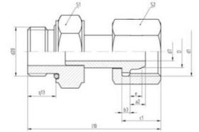
Inklusive O-Ring zur Abdichtung zwischen Anschlussnippel und Sicherheitseinrichtung
