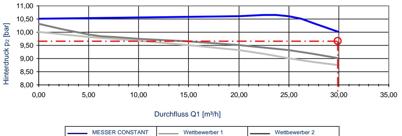
Um die Geräteklasse 3 der DIN EN ISO 2503 zu erfüllen, muss der Flaschendruckregler bei einem Vordruck  $p_1$  von 21 bar und einem Hinterdruck  $p_2$  von 10 bar einen Nenngasdurchfluss  $Q_1$  von  $30\text{ m}^3/\text{h}$  erreichen.
