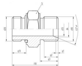
Inklusive O-Ring zur Abdichtung zwischen Anschlussnippel und Sicherheitseinrichtung
