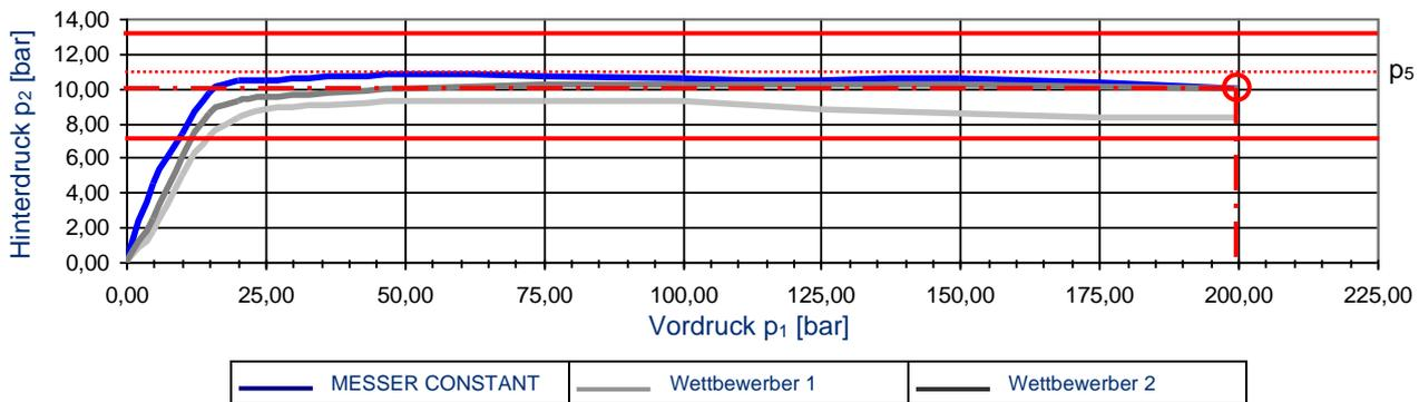
Um die Geräteklasse 3 der DIN EN ISO 2503 zu erfüllen, wird der Flaschendruckregler bei einem Vordruck  $p_1 = 200 \text{ bar}$  auf einen Hinterdruck  $p_2$  von  $10 \text{ bar}$  und einem Nenngasdurchfluss  $Q_1$  von  $30 \text{ m}^3/\text{h}$  eingestellt. Bei dieser Einstellung wird der Vordruck von  $p_1 = 200 \text{ bar}$  auf einen Vordruck für die Prüfung  $p_3 = 21 \text{ bar}$  gleichmäßig und stetig gesenkt.
