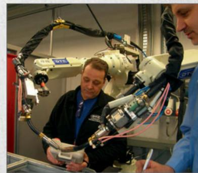
Schweißstromquellen-Test am Roboter
