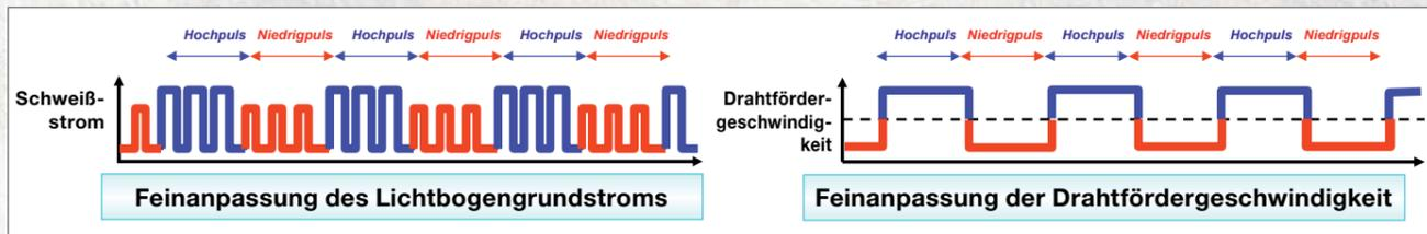
Die neue Wave-Pulse-Funktion stimmt die Schweißstromsteuerung und die Drahtvorschubgeschwindigkeitssteuerung regelmäßig ab und kontrolliert das Schmelzbad.
