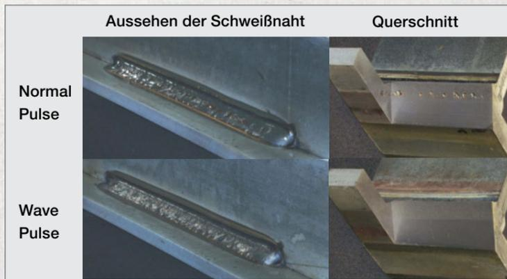
Auch bei galvanisierten Stählen, die zur Porenbildung neigen, kann die Anzahl der Poren durch die Verwendung der Wave-Pulse-Funktion erheblich reduziert werden.
