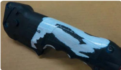
Der weiße Bereich repräsentiert den Kontakt mit der Handfläche. Wird diese Fläche vergrößert, kann der Bediener den Griff mit großer Leichtigkeit bedienen.
