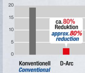
Nahtvorbereitungsfläche in mm<sup>2</sup>
