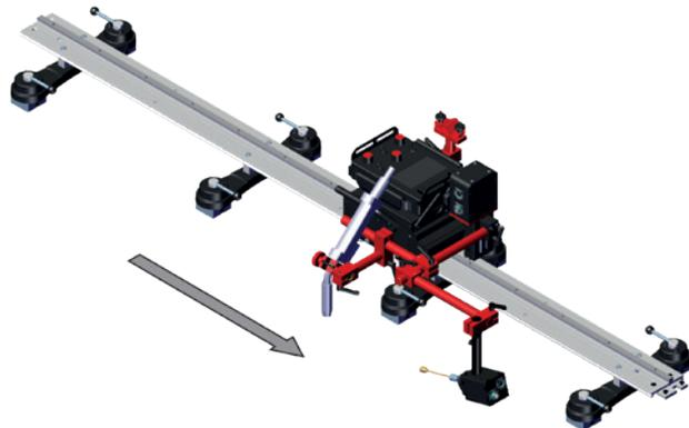
Die Konfiguration mit Nahtverfolgung in horizontaler und vertikaler Richtung erfordert einen optionalen Nahtverfolgungs-Aufsatz und einen motorisierten Vertikalschlitten
