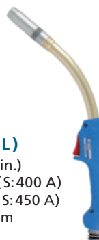
TBi 8W 100% (10 min.) Mix: 500 A CO 2 : 550 A Ø 1.2-3.2 mm
