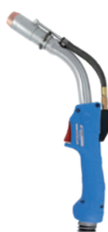
TBi 9W 3C 100% (10 min.) Mix: 600 A CO 2 : 650 A Ø 1.2-1.6 mm mit 3-Kreis-Kühlung
