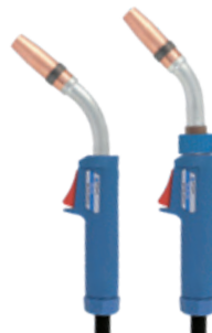
TBi 3G (DR) 60% (10 min.) Mix: 180 A CO 2 : 200 A Ø 0.8-1.2 mm
