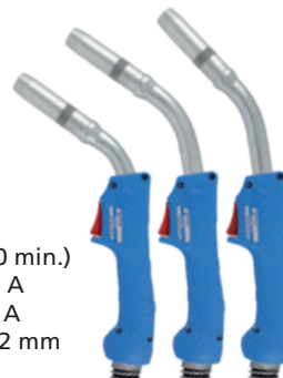
TBi 9W (S, L, Alu) 100% (10 min.) Mix: 500 A CO 2 : 550 A Ø 1.0-1.6 mm mit 2-Kreis-Kühlung
